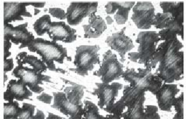
Fig. 4. Campana "San Cristobal" de la Catedral de Sevilla. Imagen metalográfica. Véase la explicación en el texto. Ataque con cloruro férrico y ácido clorhídrico. 200x.
