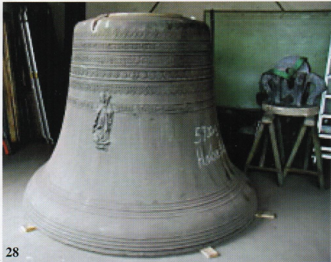
Glocke mit 6000 kg erhält neue Krone durch Einschweißen (28, 29)
