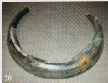
Glocke von 1589 mit 390 kg. Schlagring zu \frac{2}{3} = 1,94 m abgerissen
