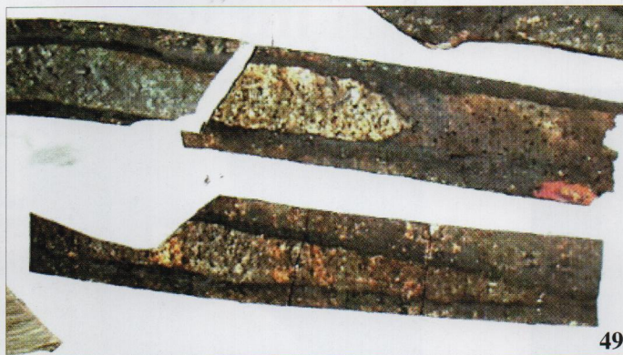
Bild 49 Rißentwicklung an der unter- schiedlichen Verfärbung erkennbar
