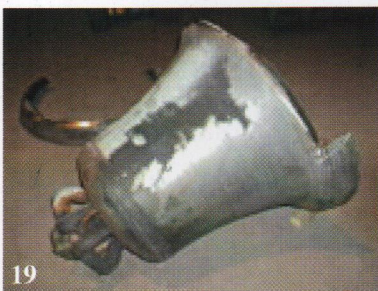
Glocke von 1589 mit 390 kg. Schlagring zu \frac{2}{3} = 1,94 m abgerissen
