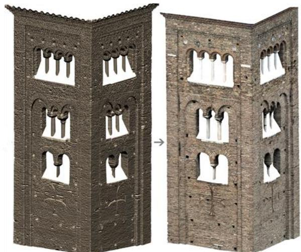
Figura 5. Nube de puntos y malla poligonal de la torre de San Francesco.
