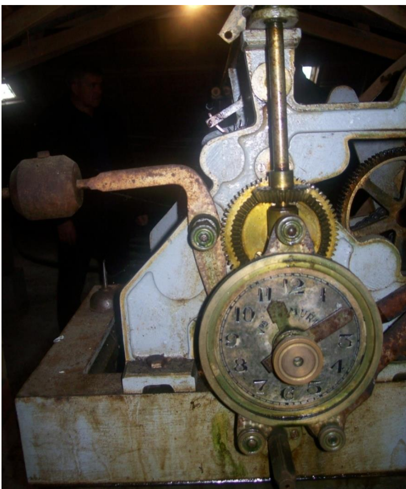
(FOTO 15) Detalle da esfera horaria para poñer a hora onde aparece o nome do fabricante: "VDA DE MURUA".
