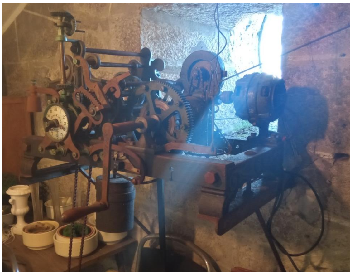
(FOTO 4) Reloxo de Meiról, en primeiro termo a manivela para subir as pesas a man e o motor eléctrico (á dereita) que o facía dun xeito automático.
