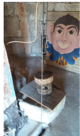
Es necesaria la supervisión exhaustiva del sistema de poleas y contrapesas del reloj, y su reparación si procede.
