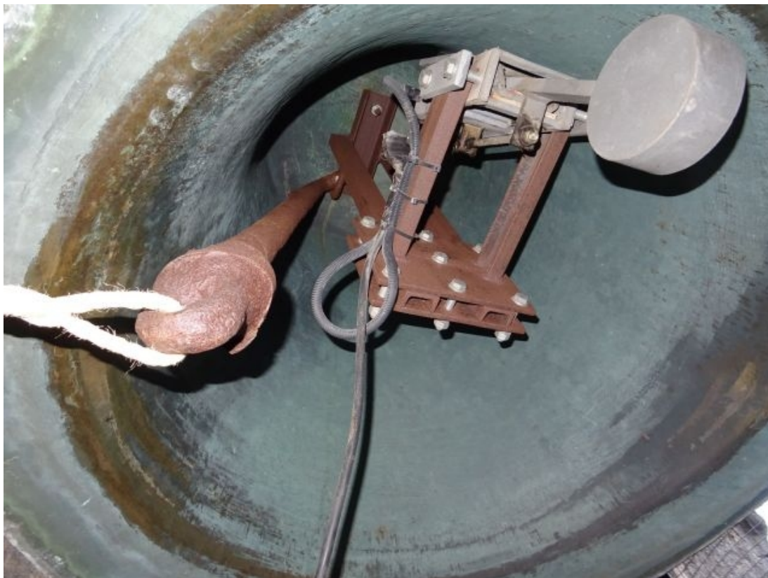
Electromazo interno y badajo provisional para el concierto (30-03-2019)
