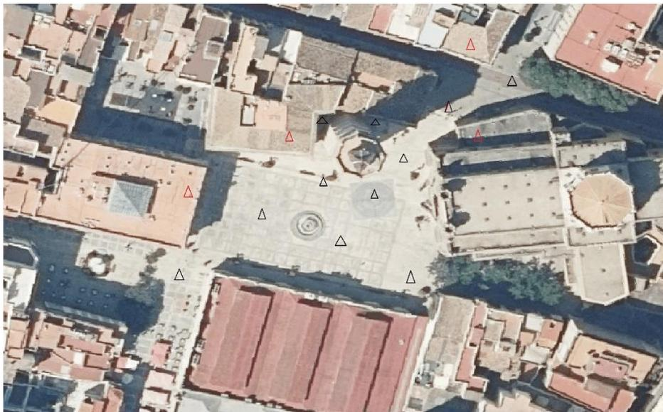
*Ilustración 10: Croquis estaciones para el escaneo de la parte externa*
