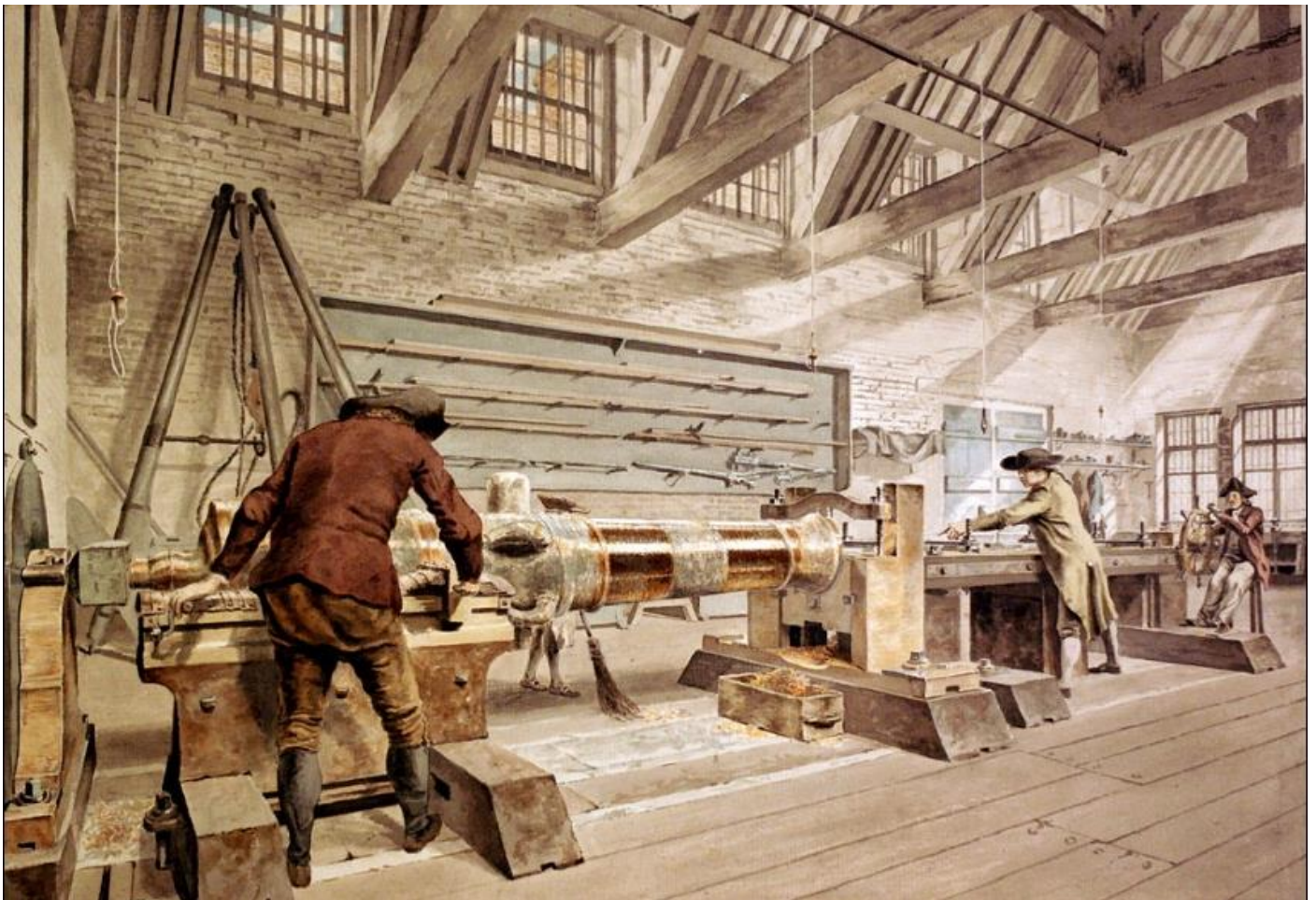
Pieter Verbruggen, 1Royal Brass Foundry, 1778. Zijn vader staat hier achter zijn uitvinding om kanonnen met een draaibank uit te boren.
