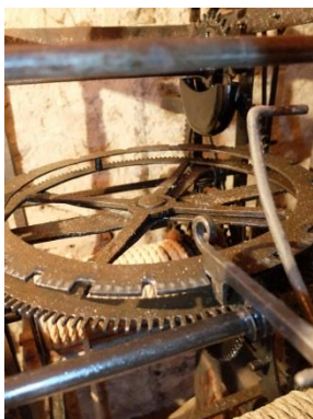
Comptadora horitzontal, d'osques exteriors (duplicades per a la repetició), interna a l'estructura i solidària a una roda dentada 43
