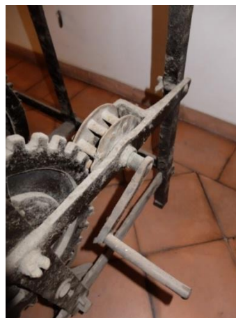
Pinyó i roda de remuntatge (reducció de velocitat) 53
