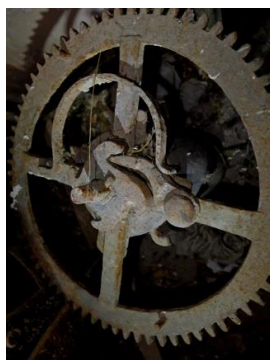
Trinquet sobre roda en estrela 57
