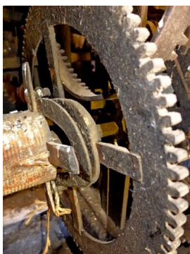
Sistema de travat de ferradura contra els braços de la roda 56
