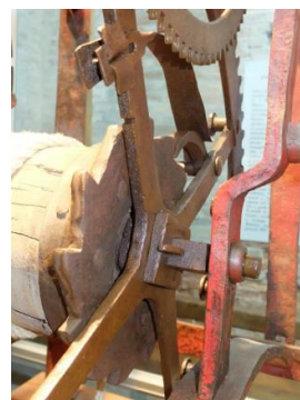
El sistema de roda roquet i trinquet 58
