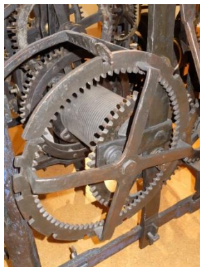
Comptadora vertical, amb osques exteriors, i externa a l'estructura 44
