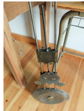
Pèndol amb sistema de compensació tèrmica 41
