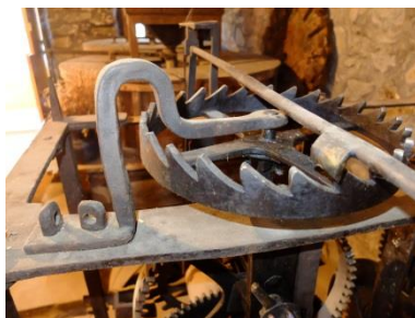
Escapament de paletes (horizantal) amb pèndol com a regulador 31
