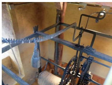
Escapament de paletes (vertical) amb foliot com a regulador 30
