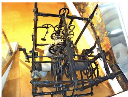
De gàbia o ferrer amb els trens enfrontats i un tercer perpendicular 21
