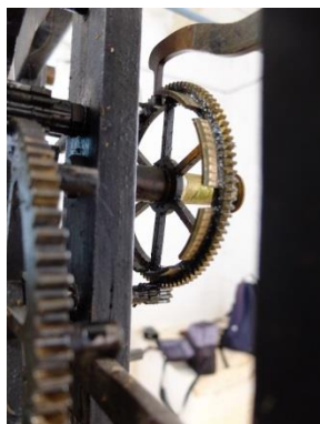
Comptadora vertical, amb osques al cercol, externa 47
