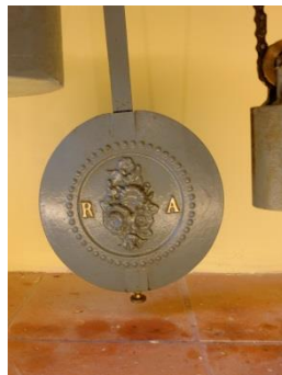
Llentilla amb ram de flors característic dels rellotges Paul Odobey, flanquejat per les lletres R i A (Retrocedir i Avançar) 17
