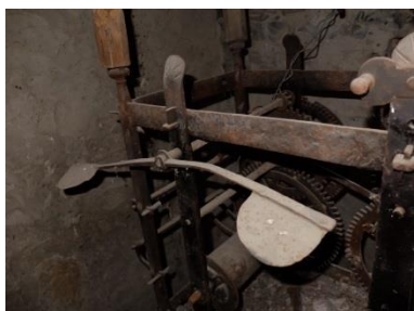
Venterol comú, amb dos pales, eix d'orientació horitzontal i extern a l'estructura 49
