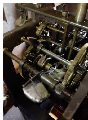
Escapament de gravetat o de força constant 36
