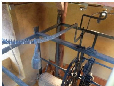
Escape de paletas (vertical) con volante como regulador 30
