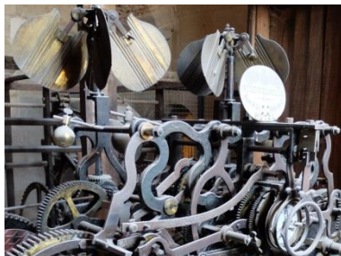
Venteroles de cuatro palas, externos y con ejes de orientación vertical 49
