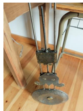
Péndulo con sistema de compensación térmica 40
