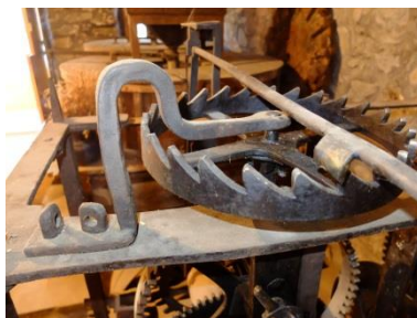
Escape de paletas (horizontal) con péndulo como regulador 31
