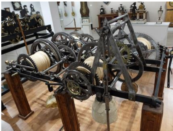
Horizontal o bastidor de cama 24
