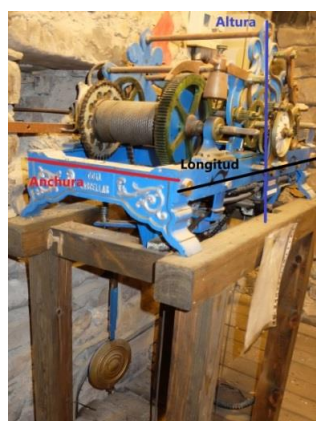
Medidas en un reloj de chasis industrial 5
