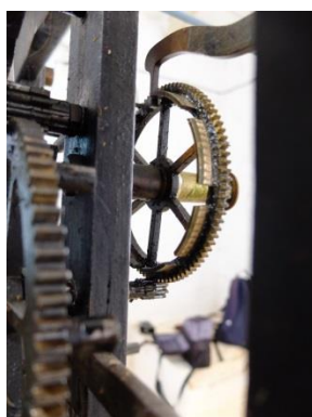
Contadera vertical, con muescas en el aro, externa 46
