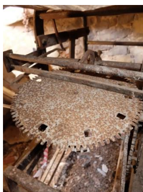
Contadera horizontal, con orificios e interna a la estructura 45
