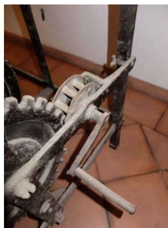
Piñón y rueda de remontaje (reducción de velocidad) 52
