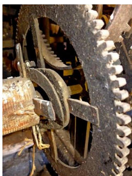
Sistema de trabado de herradura contra los brazos de la rueda 55
