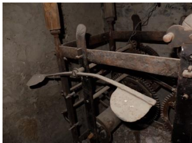
Venterol común, con dos palas, eje de orientación horizontal y externo a la estructura 48
