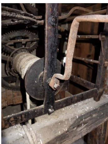
Remontaje directo sobre el eje 53
