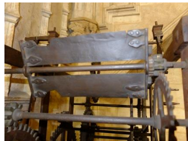
Venterol de dos palas, eje de orientación horizontal, interno a la estructura 50
