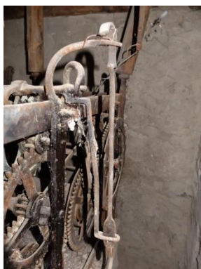
Péndulo con varilla metálica 38
