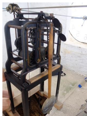
Péndulo con varilla de madera 39
