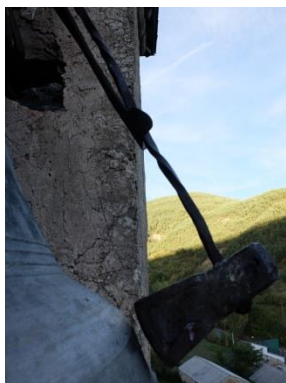
Mazo, de forja y separado de la campana por una ballesta (posición: 00) 67
