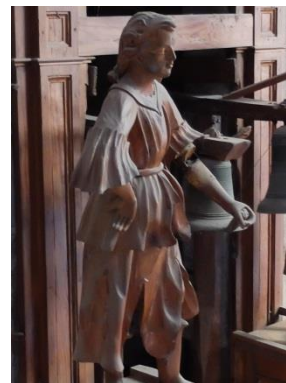
Tardón. Este golpea la campana con un mazo en la mano mediante un brazo articulado 70
