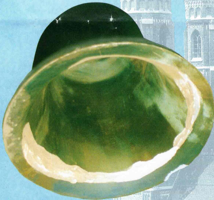
Glocke mit ausgeschlagenem Schlagring
