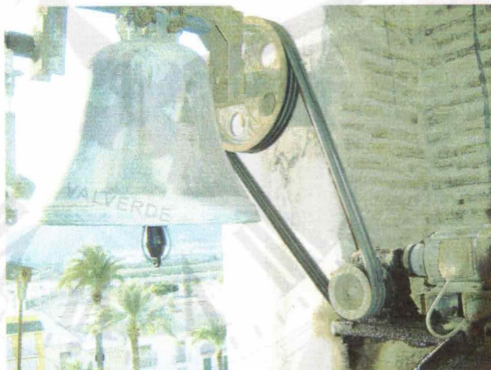
Detalle sistema de volteo continuo con reductora
