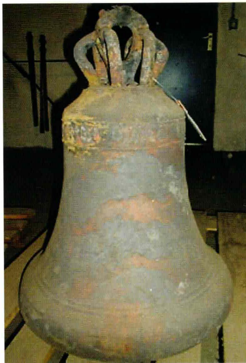
13 Gleiche Glocke nach der Schweißung
