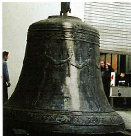
Freiheitsglocke Berlin, 9540 kg Risslänge: 1,36 m
