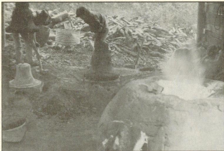
El horno encendido funde el metal durante aproximadamente 30 horas; la temperatura debe alcanzar alrededor de 1000 grados. Mientras, se cuecen y se entierran los moldes para las campanas.
