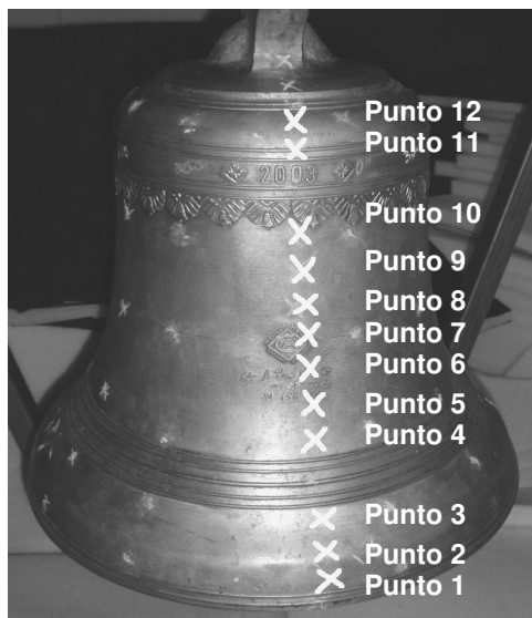
Fig. 2.14 - Puntos de medida de espesor con ultrasonidos
