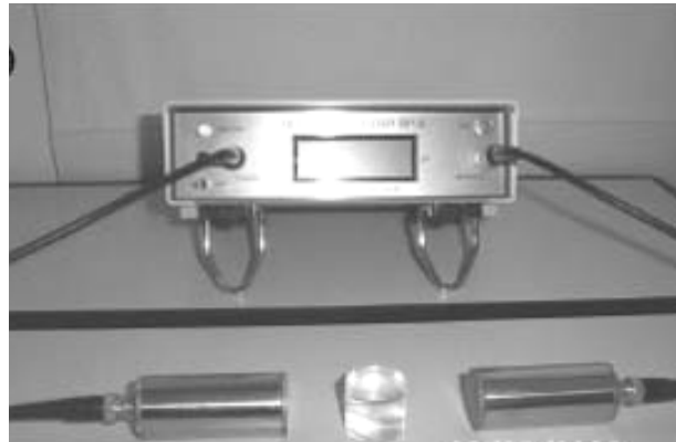
Fig. 2.11 – Ultrasonic Tester BP-5, Steinkamp
